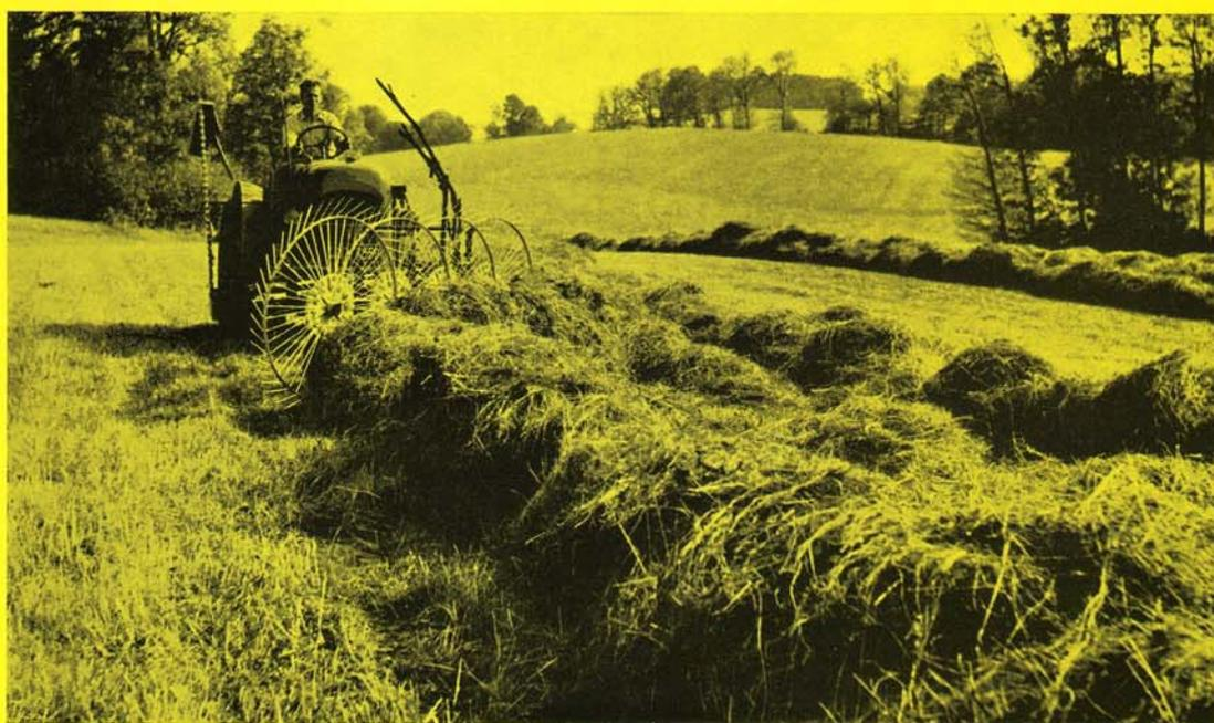
Die **Front-HEUMA** erlaubt den Arbeitseinsatz im Schau-Voraus-System. Sie kann zum Schwaden ziehen, Schwadenwenden und Zusammenrechen verwendet werden.
